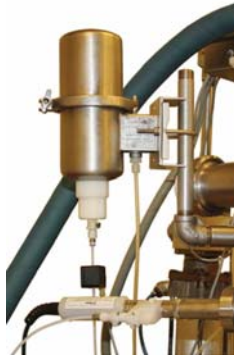
Ceramax CPS341D en acero recubierto y esmalte sensible al pH.
