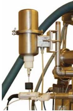
Ceramax CPS341D en acero recubierto y esmalte sensible al pH.
